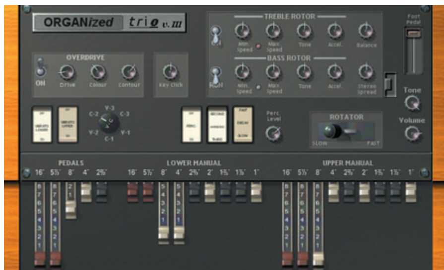
fig. 1 – l'interfaccia di ORGANized trio mostra i tre set di drawbars e tutti i controlli relativi alla percussione, al vibrato/chorus e al simulatore di cassa Leslie incorporato
